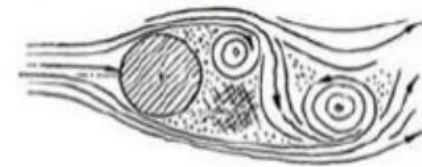
Ροή γύρω από κύλινδρο για 10^4 < Re_D < 10^5 , με περιοδική ταλάντωση των δινών στροβιλότητας von Karman μέσα στον ολκό και c_D = 1.2
