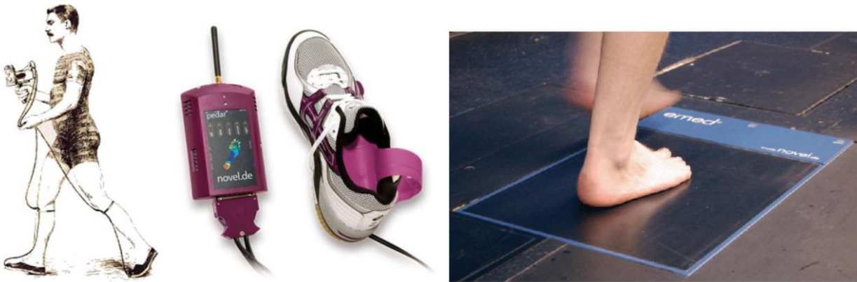
Εικόνα 1: Υποδήματα καταγραφής πίεσης του Marey (αριστερά), σύγχρονος αισθητήρας πελματιαίας πίεσης ενσωματωμένος σε υπόδημα (στο κέντρο) και αισθητήρας πελματιαίας πίεσης σε πλατφόρμα (δεξιά).
