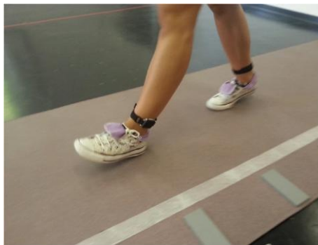
Εικόνα 3: Συμμετέχων με δύο αδρανειακούς αισθητήρες στερεωμένους στο κάτω μέρος της κνήμης, πάνω από τους αστραγάλους, κατά τη βάδιση [12].
