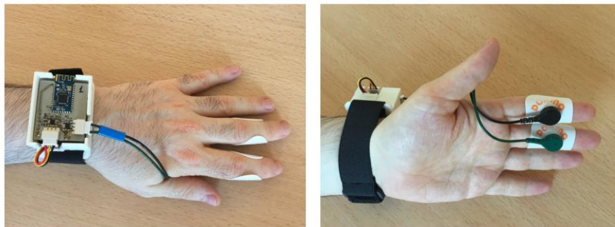
Εικόνα 2: Φορητός αισθητήρας ηλεκτροδερμικής δραστηριότητας στερεωμένος στον καρπό του μη κυρίαρχου χεριού (αριστερά) και τοποθέτηση των δύο ηλεκτροδίων στην παλαμιαία επιφάνεια του δείκτη και του μέσου δακτύλου (δεξιά) [16].
